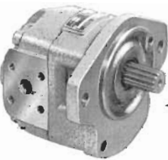
Wellenende Zahnwellenprofil DIN 5480 mit Vorsatzlager, Befestigungsflansch nach SAE-Norm
